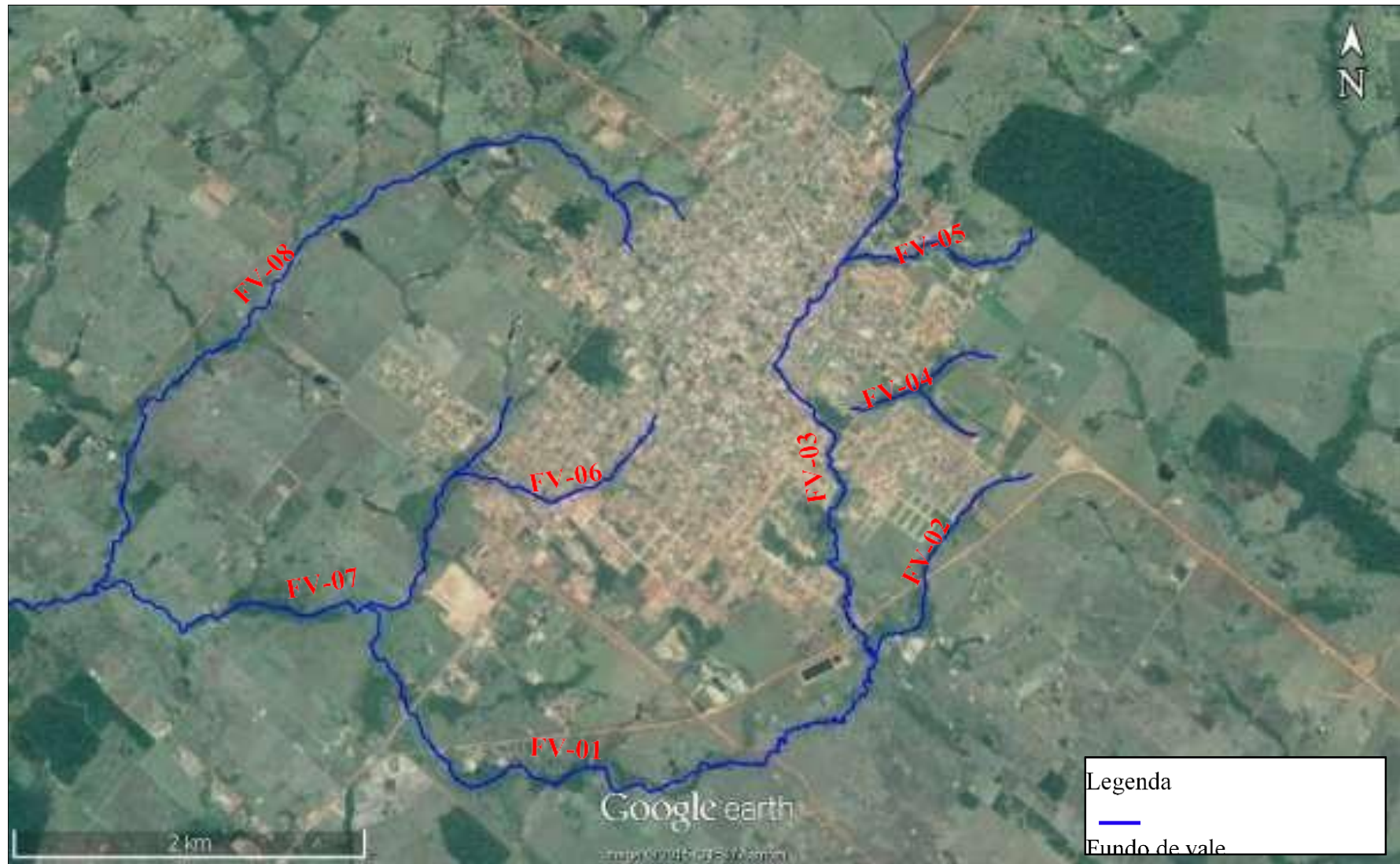
Figura 81 - Principais fundos de vale por onde ocorre o escoamento de águas pluviais no perímetro Urbano da Sede Municipal Fonte: Adaptado do Google (2015).
